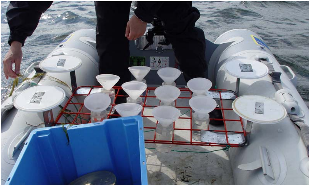
Mynd 10. Trektargildra á hvolfi. Breiðu fötulokin fjögur eru fætur gildrunnar og koma í veg fyrir að trektarnar sökkvi á kaf í botnefjuna. Trektarnar eru 3-5 cm yfir botni.
