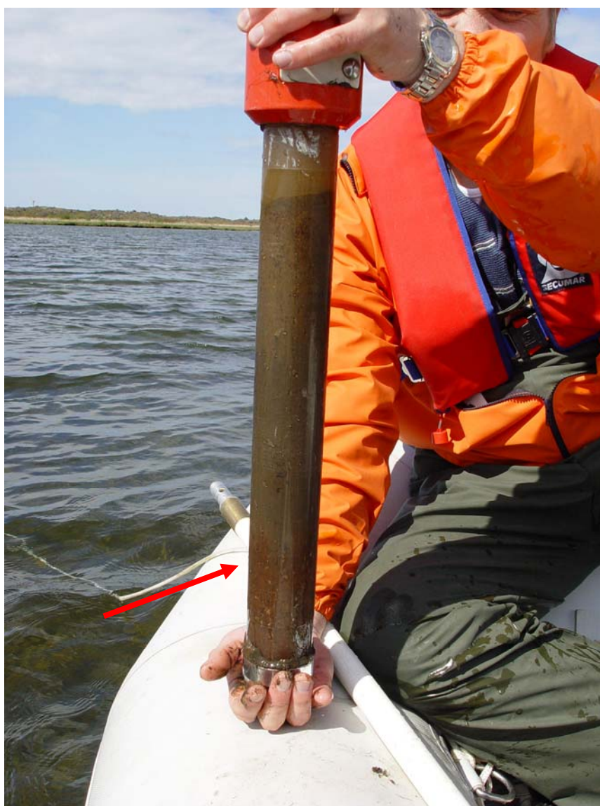
Mynd 9. Kajakrör úr Urriðavatni með setsýni úr efsta lagi botnsins. Neðarlega í kjarnanum (sjá ör) má greina mólagn og ofan á honum er dæmigert vatnaset.
